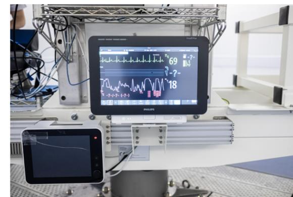
↑ Sur la centrifugeuse, les paramètres vitaux (électrocardiogramme, pression artérielle, fréquence cardiaque, fréquence respiratoire, saturation en oxygène, etc...) sont enregistrés et transmis sur un écran de la salle de contrôle et sont ainsi surveillés par le médecin en temps réel.
